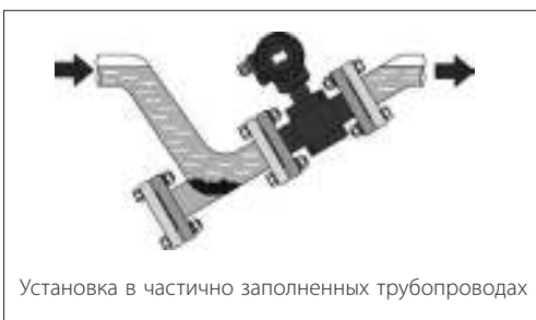
Расходомер устанавливается электронным блоком ВВЕРХ
